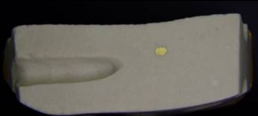
15 - Vista da base do modelo inferior com recorte feito para melhor acomodação do pino de travamento
