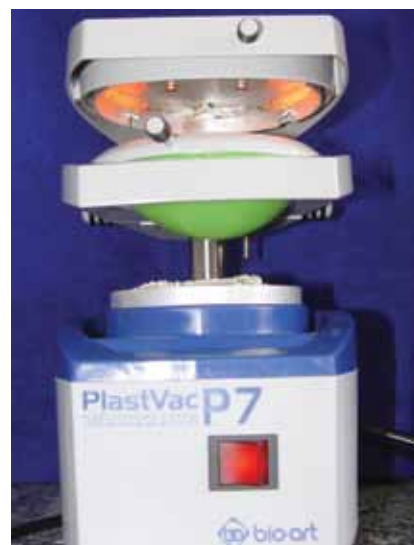
Figura 6 - Consistência da placa de EVA após o aquecimento.
