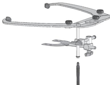
O pino de apoio do arco facial standard é utilizado durante a transferência do registro do paciente para o articulador, proporcionando maior praticidade e estabilidade durante a montagem do modelo superior. Manualmente rosqueie até o final o pino de apoio na haste da trave do arco, conforme mostrado nas figuras ao lado. (não utilize nenhum tipo de chave).
