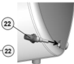
**Nota:** A inserção ou a retirada para limpeza do filtro interno (22) é de forma deslizante e suave, não há nenhum tipo de rosca para inserção ou remoção da câmara e deve ser feita manualmente. Não utilize nenhum tipo de ferramenta ou chave.
