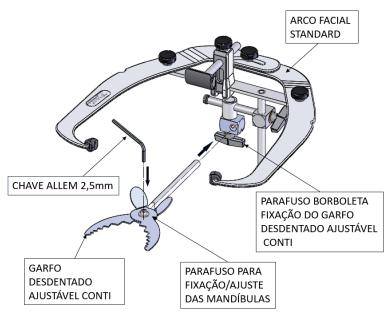
**Imagem 2:** Garfo Desdentado Elite sendo montado no Arco Facial Elite: a fixação do garfo se faz através do aperto do parafuso de fixação do arco.
